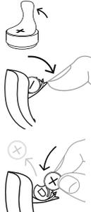
Retire a proteção adesiva da pilha nova e certifique-se de que a pilha não fica com resíduos de substâncias pegajosas. Deixe-a "respirar" durante 60 segundos.
